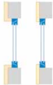
Slika 18: Detalj pravilnog postavljanja toplotne izolacije uz okvir prozora
