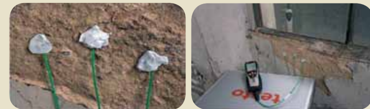
Slika 9: Postupak mjerenja U-vrijednosti spoljašnjeg omotača in-situ
