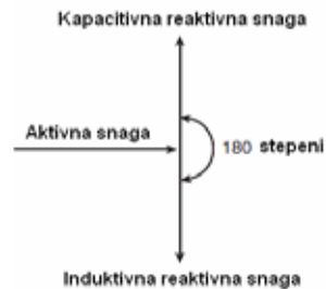
Slika 46: Induktivni i kapacitivni karakter reaktivne snage
